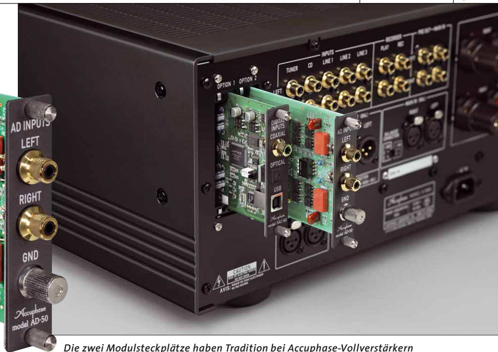
Die zwei Modulsteckplätze haben Tradition bei Accuphase-Vollverstärkern
